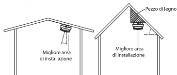
Figura 6-3 Posizione di installazione (2)
